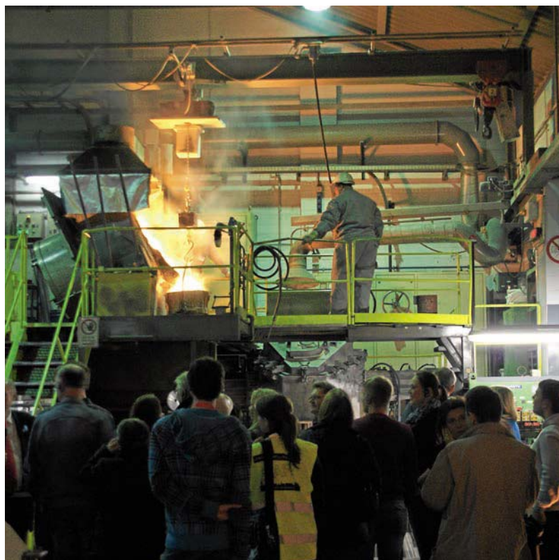
Beschickung einer Stranggussanlage mit Bronze.
